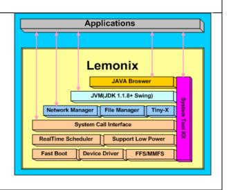
Lemonix Real-Time Linux 는 표준 리눅스 커널의 구조적인 문제를 수정하여, 표준 리눅스 커널이 가지고 있는 각종 장점을 누림과 동시에 Real Time 을 지원하도록 설계되었다. 표준 리눅스 커널은 전통적인 유닉스의 모노리틱(monolithic) 기반의 커널이므로, 처리량(Throughput)을 중시하여, 실시간적 성격을 표시하는 응답성(responsibility)과는 지향하는 바가다르다. 따라서, 본 Lemonix 운영체제는 응답성을 높여 실시간성을 지원하기 위해, 커널 자체의 락메커니즘(lock mechanism)과 관련된 커널코드를 수정하여 선점형 커널(preemptible kernel) 방식으로 작성되었고, 락브레이크(lock break) 기법을 도입하여 커널 내부의 긴 락구간(long locked region)으로 응답성이 현저히 떨어지는 점을 보완, 긴 락구간 안 에서도 태스크의 선점(preemption)이 허용될 수 있도록 하였다.
